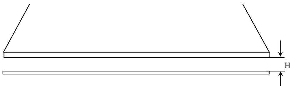
图 5 CTA 薄膜剂量带在引出窗下安装示意图
